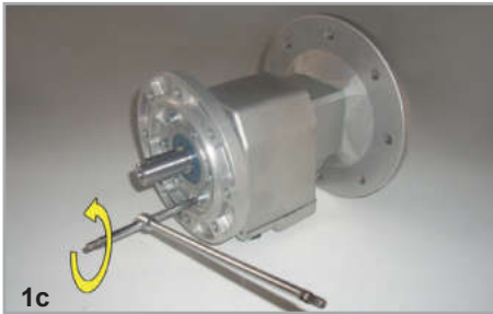
1c) Desserrer et enlever les vis qui fixent la bride du corps du réducteur.
