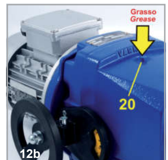
12b) Introduire 0,19 kg (*) de graisse synthétique SHELL RETINAX EPX2 par le bouchon 20.
